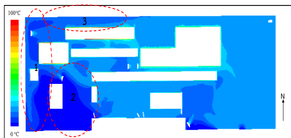
รูปที่ 10 การกระจายตัวของอุณหภูมิภายในโรงงาน กรณีศึกษา 1
