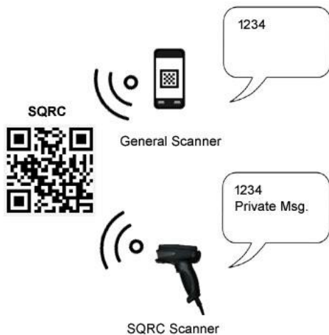
รูปที่ 7 การอ่านข้อมูลจาก SQRC
