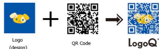
รูปที่ 9 การสร้าง LogoQ จาก LogoQ algorithm (Denso Wave, Inc., 2016e)
