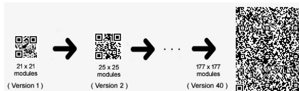
รูปที่ 2 การเพิ่มจำนวนโมดูลในแต่ละเวอร์ชันของ QR Code
